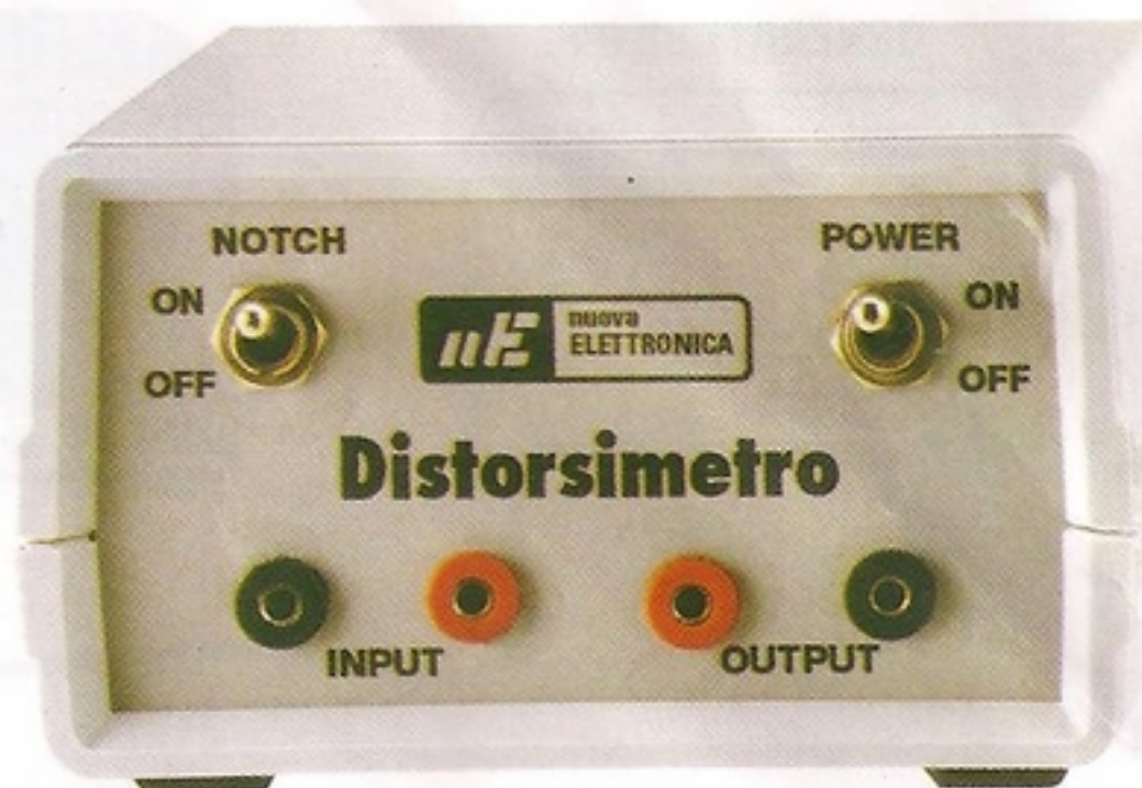
Fig.6 Foto della mascherina in alluminio del mobile destinato a questo progetto, già forata e serigrafata.
