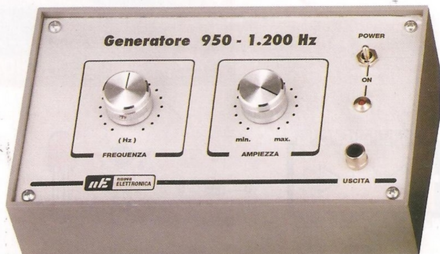
Fig.8 Ecco come si presenta il Generatore di BF LX.1744 che provvede a fornire un'onda sinusoidale da 950 a 1.200 Hz.
