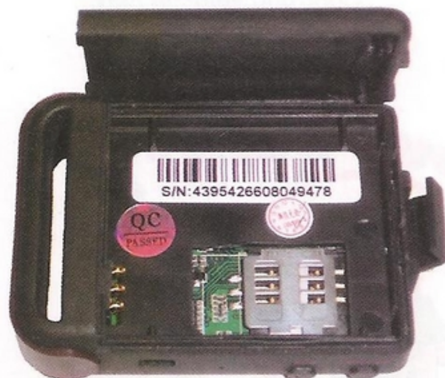
Fig.10 Aprite TRACKER tirando verso l'esterno la leva in basso e alzate il coperchio per inserire negli spazi previsti la scheda SimCard e la batteria, quindi chiudete il coperchio.
