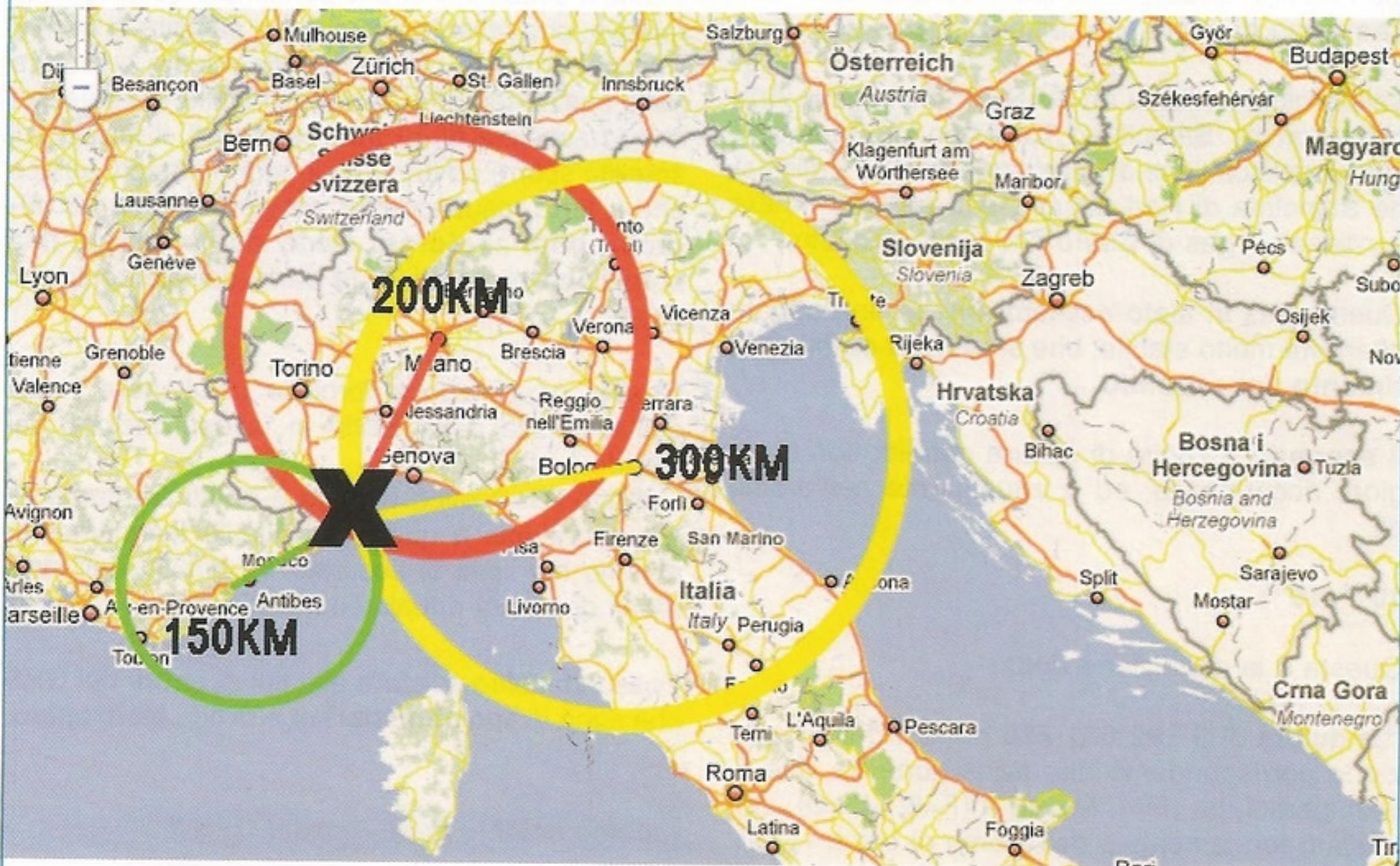
Fig.7 Il satellite trova la vostra posizione facendo intersecare le circonferenze in modo tale da localizzare un punto e uno solo.
